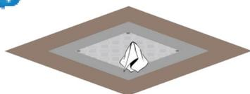
Una volta che il cemento ha raggiunto l'80% della durezza pulite i profili a vista del chiusino
