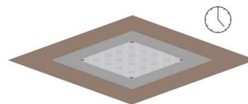
Cementate l'esterno del chiusino totalmente o a filo della pavimentazione. Fate attenzione a proteggerlo sia viti che profili dal cemento. Non appena il telaio esterno ha fatto presa con il cemento non si potrà più
