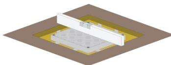
Posizionate il telaio esterno nel foro sul pavimento e verificate che superi la pavimentazione di ca. 2,5cm. Dovrebbe esserci minimo uno spazio di 100 mm da poter cementare. Attenzione: il chiusino deve essere chiuso.
